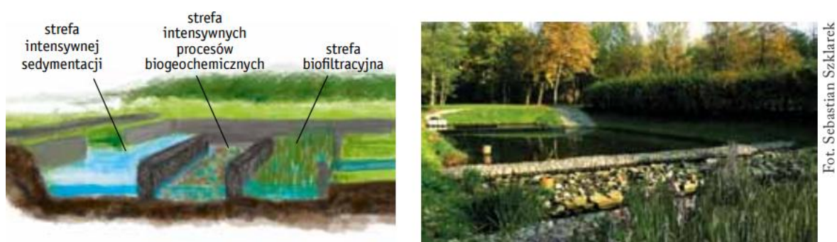
Rys. 2. Sekwencyjny System Sedymentacyjno-Biofiltracyjny na rzece Sokołówce (Wagner i Krauze, 2014)
